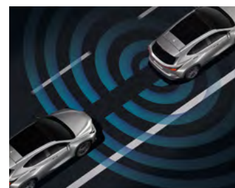
Pomoć za siguran izlazak koristi nadzor mrtvog kuta za detekciju prometa kao što su automobili ili biciklisti koji dolaze odostraga i ako je potrebno držati vrata zatvorena.
